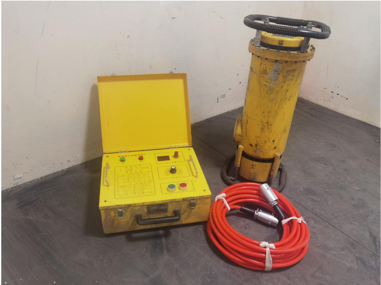
图2-4 典型定向 X 射线探伤设备基本组成图
