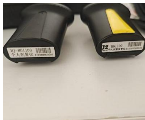
RG1100 型个人剂量报警仪
