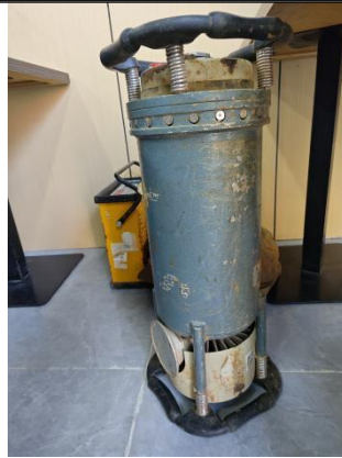
XYG2505 型便携式 X 射线探伤机（主视）
