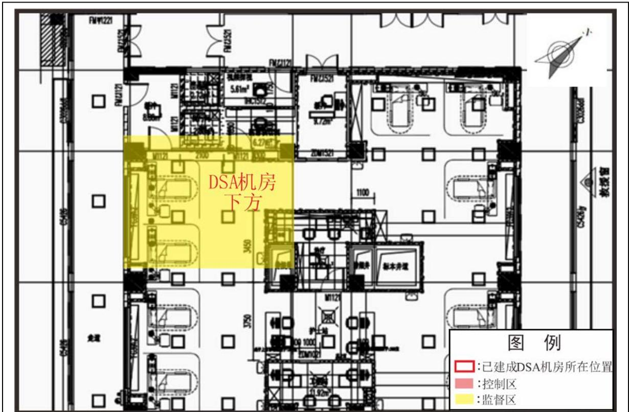
图 3-5 北楼 4 层 DSA 机房下层（即北楼 3 层）分区管理示意图
