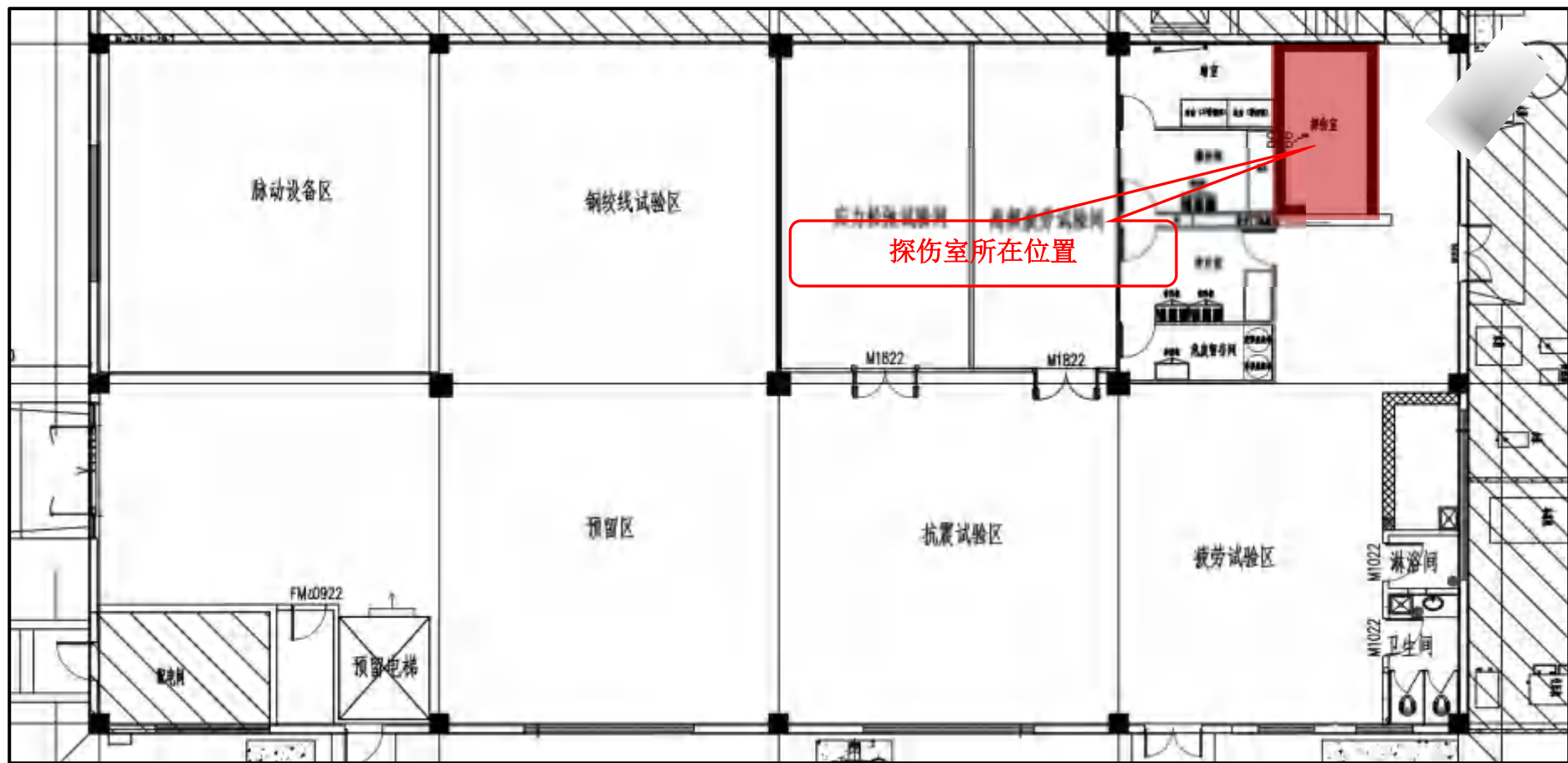
图2-2 探伤室所在位置及原涂料车间平面布局图
