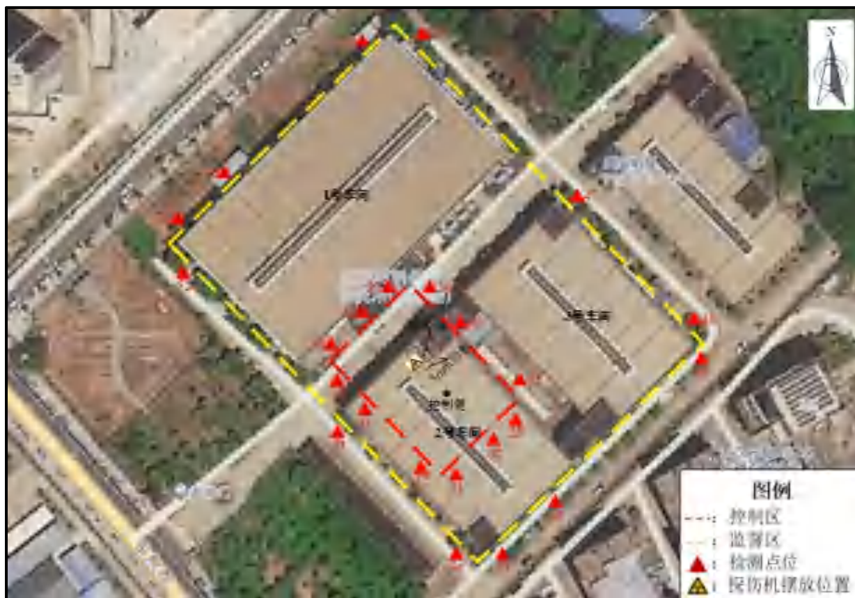
图 6-3 移动式探伤所在区域周边辐射环境检测点位示意图
