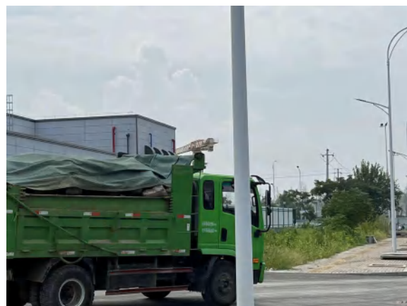
运输车土工布覆盖
