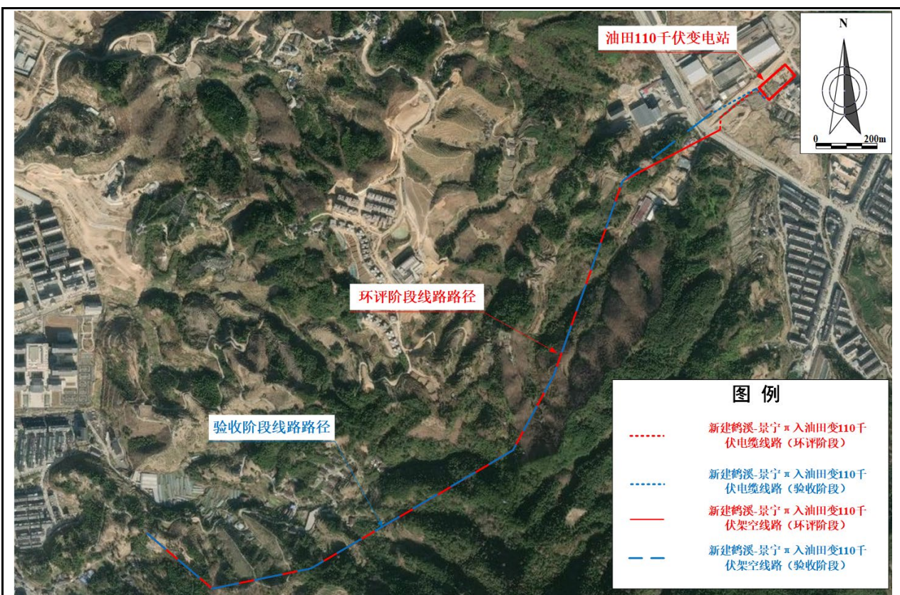
图 4-5 本项目新建线路路径环评阶段与验收阶段对比图
