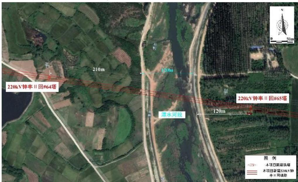
图8-2 220kV钟丰 II 回线路#64~#65塔段跨越漂水示意图
