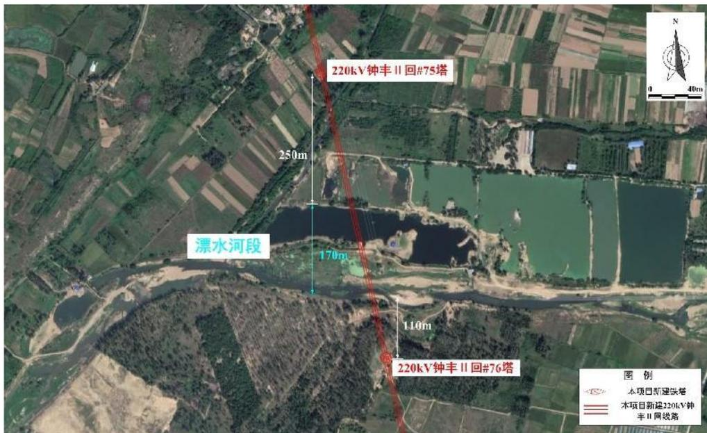
图 8-1 220kV 钟丰 II 回线路#75~#76 塔段跨越漂水示意图
