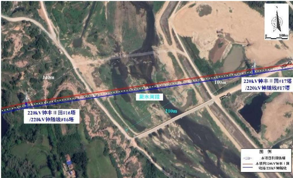
图8-5 220kV钟丰 II 回#16~#17塔（220kV钟随线#16~#17塔）段跨越厥水河段示意图
