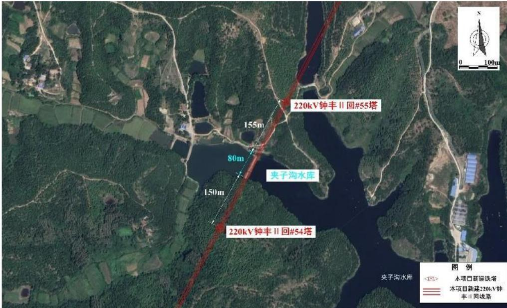
图 8-4 220kV 钟丰 II 回线路#54~#55 塔段跨越夹子沟水库示意图
