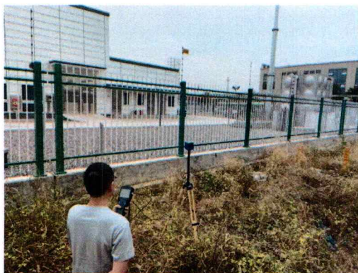
站址东侧电磁环境现状检测
