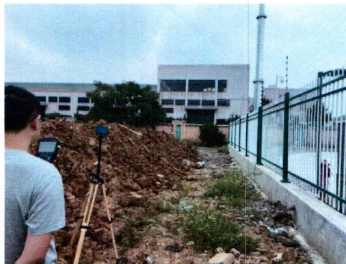
站址南侧电磁环境现状检测
